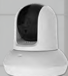
دوربین تحت شبکه ۳۶۰ درجه میکروفون داخلی - دارای پورت شبکه SD CARD
